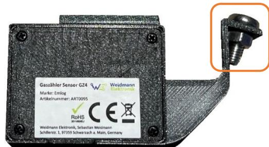
**Schritt 3:** Führen Sie den Sensor GZ4 in die dafür vorgesehene Aussparung (A) bis zum Anschlag ein, bis der Sensor bündig mit der seitlichen Befestigungslasche Ihres Zählers abschließt (B).
