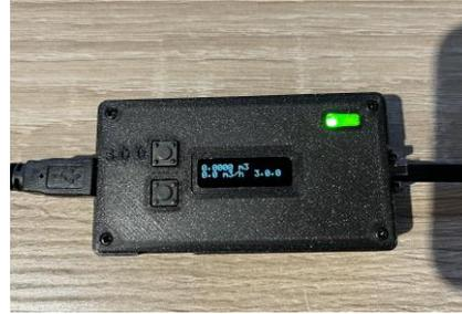
**Schritt 7:** Konfigurieren Sie über die Taste 3.0.0 die Impulse pro m<sup>3</sup> (Standard 100 Imp/m<sup>3</sup>). Die Zahl finden Sie auf Ihrem Zähler mit z.B.:
