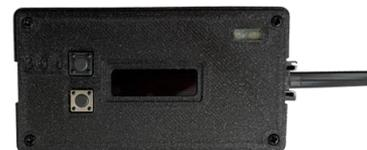
**Schritt 6:** Verbinden Sie die Gas Box über USB mit Ihrem Raspberry Pi oder Emlog Gerät. Die Box startet nach einer kurzen Wartezeit.
