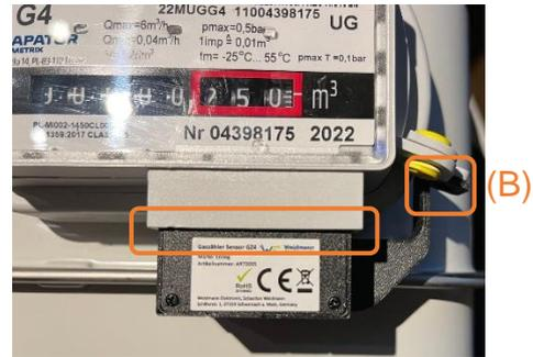
**Schritt 4:** Fixieren Sie den Sensor abschließend mit der zuvor entfernten Schraube.
