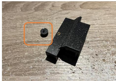
**Schritt 2:** Führen Sie den Sensor GZ3 in die dafür vorgesehene Aussparung (A) bis zum Anschlag (B) ein.
