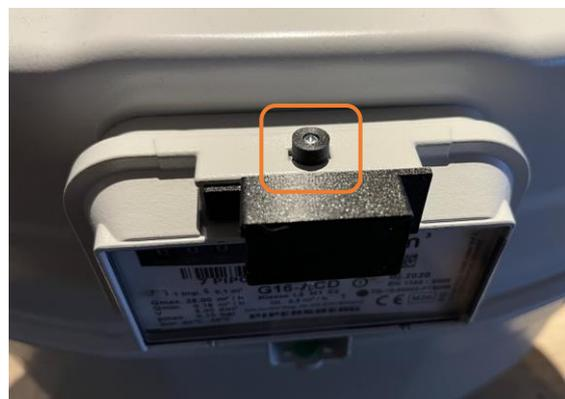
**Schritt 4:** Verbinden Sie nun den Sensor GZ3 mit der Gas Box mittels des mitgelieferten Rj10 Kabels.
