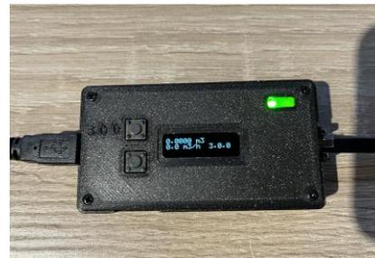
**Schritt 6:** Konfigurieren Sie über die Taste 3.0.0 die Impulse pro m<sup>3</sup> (Standard 100 Imp/m<sup>3</sup>). Die Zahl finden Sie auf Ihrem Zähler mit z.B.:
