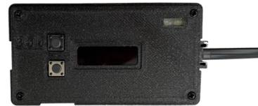
**Schritt 5:** Verbinden Sie die Gas Box über USB mit Ihrem Raspberry Pi oder Emlog Gerät. Die Box startet nach einer kurzen Wartezeit.
