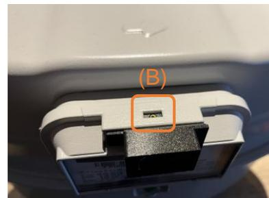
**Schritt 3:** Fixieren Sie den Sensor abschließend mit der zuvor entfernten Schraube. Drehen Sie die Schraube nicht zu fest an! Es ist kein zusätzlicher Schraubendreher nötig.
