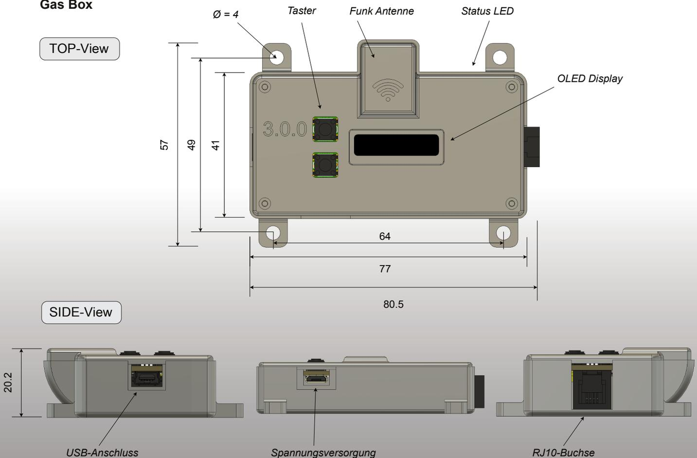
ZEICHNUNG (alle Abmessungen in mm)
