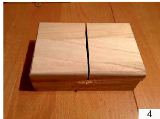
Entfernen Sie den Verschluss am Deckel, alle Scharniere und Schrauben an der Holzbox mit dem 3mm Schraubendreher. Der untere Teil vom Verschluss kann an der Box bleiben. Danach nehmen Sie beide Deckelhälften und schleifen die Schnittstelle mit dem Schleifpapier ab, um eine saubere Kante zu erhalten.
