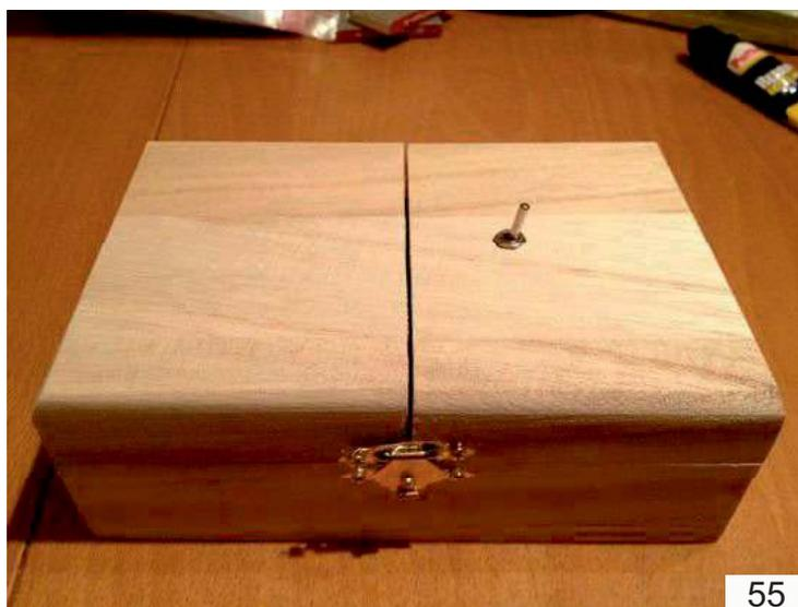
Setzen Sie nur noch den Schraubenkopf in den Kleber. Prüfen Sie nochmal, ob sich der Deckel der Useless Machine weiterhin schließen lässt. Lassen Sie den Kleber ca. 2 Stunden trocknen.
